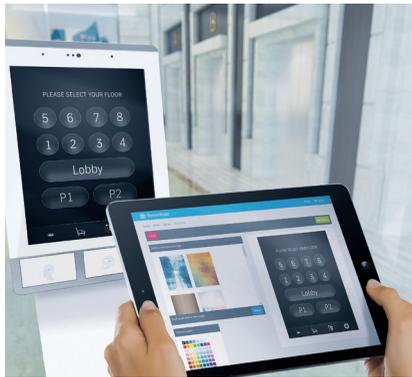
Die digitale Lösung »Agile« von thyssenkrupp verbindet ein intelligentes Zielwahlsteuerungssystem mit Zutrittskontrolle und einem zentralen Gebäudemobilitätsmanagement.
